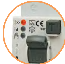
KZS EDI - "OFF" Отключен от срабатывания тепловой или электромагнитной защиты (горит красный LED)
