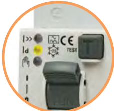
KZS EDI - "OFF" Отключен от срабатывания диф. защиты (горит желтый LED)
